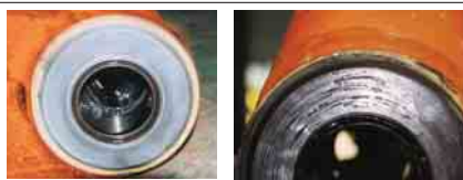
WC溶射处理-ZAXIS330: 无伤痕(1,000小时未加油) 未做WC溶射-EX300-s: 有伤痕(300小时未加油)
