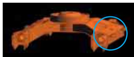
下部行走体的设计结构易于清除泥土
