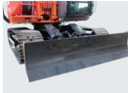
●林业专用推土板 不仅可以进行林地平整作业，而且可以提高在林地作业时的稳定性
