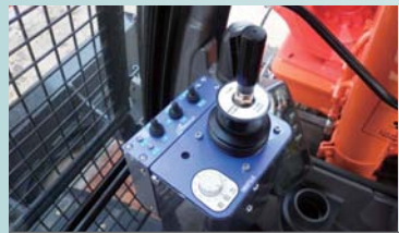
●驾驶室吊运操作系统
