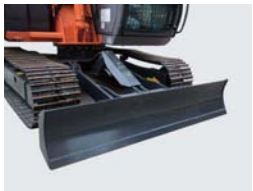
●推土板 不仅可以进行林地平整作业，而且可以提高在林地作业时的稳定性
