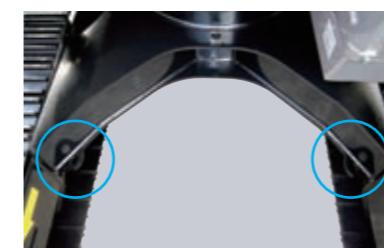
在行走架下方的法兰上，前后共设置了 4 个运输时用来固定机器的孔。
