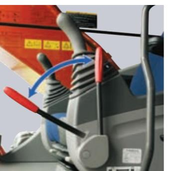
如果不完全锁定锁杆，就无法启动发动机。避免了操纵杆的意外动作。
