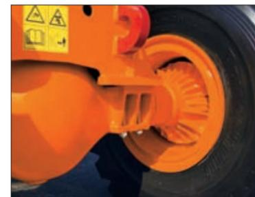
以外置方式安装的密封湿盘式制动器可产生充足的制动力,并能防止灰尘进入。前后车桥采用独立制动控制线程(双线程),提高了安全性。
