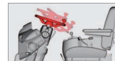
转向柱可以倾斜和伸缩，可以为各种体形的操作人员提供舒适的坐姿进行操作。
