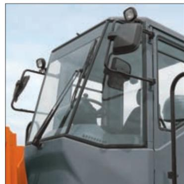
驾驶室内部和外部安装的后视镜给操作人员带来了良好的视野。前挡风玻璃采用平面玻璃，通过橡胶衬垫安装，更换容易。为了操作人员的舒适感，驾驶室安装在弹性支座上以吸收冲击和噪音。
