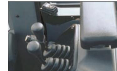
将方向开关布置在控制杆旁边，从而方便改变行走方向的操作。操作人员无需将手从方向盘上移开。
