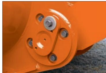
铲斗铰链销采用密封式结构，以保持内部的润滑脂，从而延长使用寿命。
