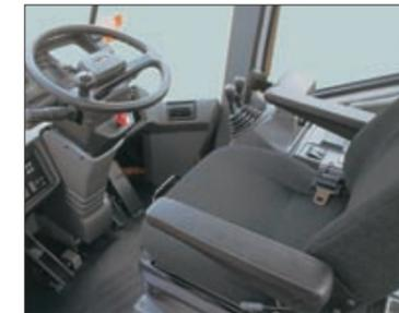
设计舒适的悬浮式座椅，减轻了操作人员的疲劳感，提高了生产率。
