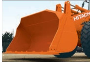
强力提升臂和连杆机构可在挖掘机进行挖掘、装载和牵引等作业中提高生产力。强大的铲斗掘起力和理想的铲斗翻角带来更高的生产力和良好的载荷保持力。铲斗设计和形状可实现高效率铲取和装载作业。通过螺栓固定的切削刃易于更换。同时标配铲斗找平装置和动臂外伸系统。
