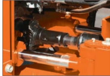
万向接头采用密封式结构，将润滑间隔延长至最长12,000小时，从而简化了维护并提升了耐久性。
