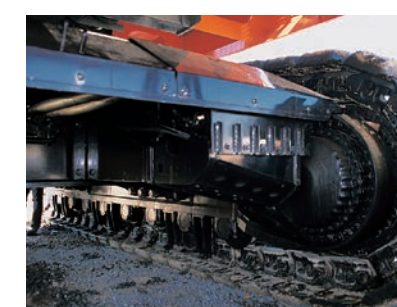
行走马达和选购的行走马达护罩采用高位设计且结构紧凑，有助于提高在多岩石工况的耐用性
