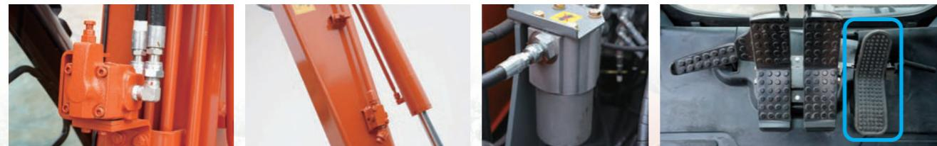
配备二次溢流阀，缓解破碎作业对液压系统的冲击。
