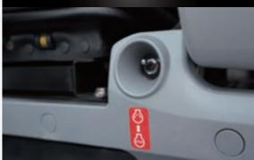
在发动机发生意外故障时，可以快速关停发动机。
