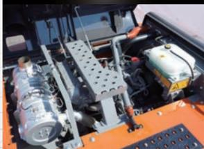
全新大功率发动机，搭载了后处理滤清器和大型双联EGR冷却器，性能成熟稳定、系统简单维护。废气排放符合国四标准。
