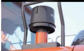
有助于延长空气主滤的使用寿命，保护发动机。
