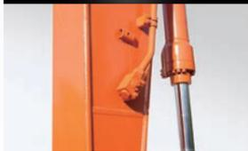
斗杆前端配置油路截止阀。另外，标配了可安装旋回配管的螺纹座。
