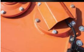
带高性能液压油滤清器。带堵塞报警传感器，堵塞时，驾驶室显示屏出现堵塞指示。
