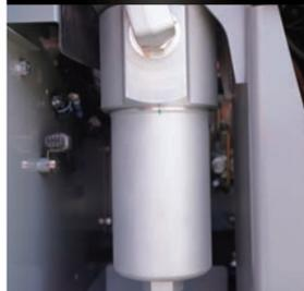
对通过破碎锤进入液压系统的杂质进行过滤，保护液压部件。
