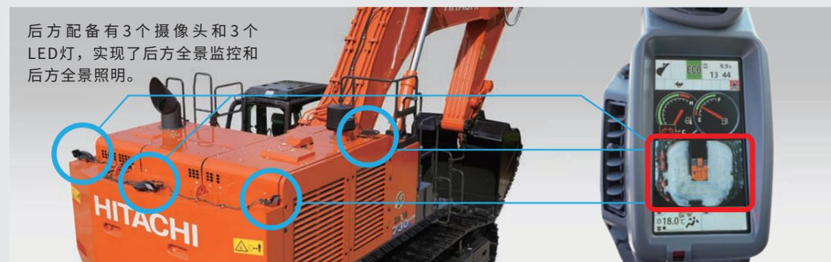
后方配备有3个摄像头和3个LED灯，实现了后方全景监控和后方全景照明。
