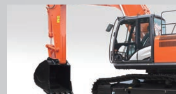
采用加强型斗杆，斗杆上装备了补强板和加强筋，而且配置了配管支座。
