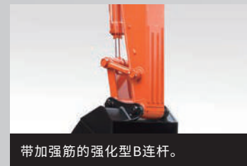
采用加强型斗杆，斗杆上装备了补强板和加强筋，而且配置了配管支座。
