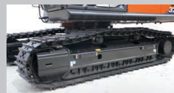
下车标配全护轨，能更好的保护下车链轮。并采用了加强型行走架。
