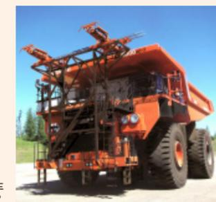
无轨充电式刚性自卸卡车 “EH5000AC-3”
