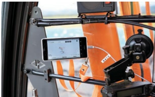
Solution Linkage Mobile的地图界面。以图符显示与GPS收发机连接的机器以及作业人员位置信息和一览表。
