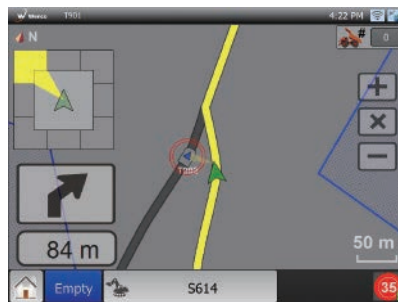
当接近了其他的自卸卡车和矿山机械时，会发出正确的警告。在有起伏的交叉点处以及夜间等很难看清的状况下，有助于防止碰撞和接触的「Fleet Awareness V2X」
