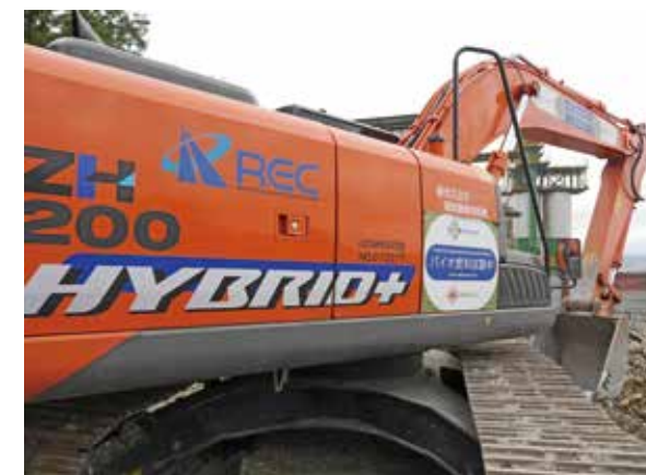
试验使用了混合动力液压挖掘机ZH200。负责机器操作的前田道路协作公司的操作人员表示：“无损操作性能，与柴油的功率相同”。
