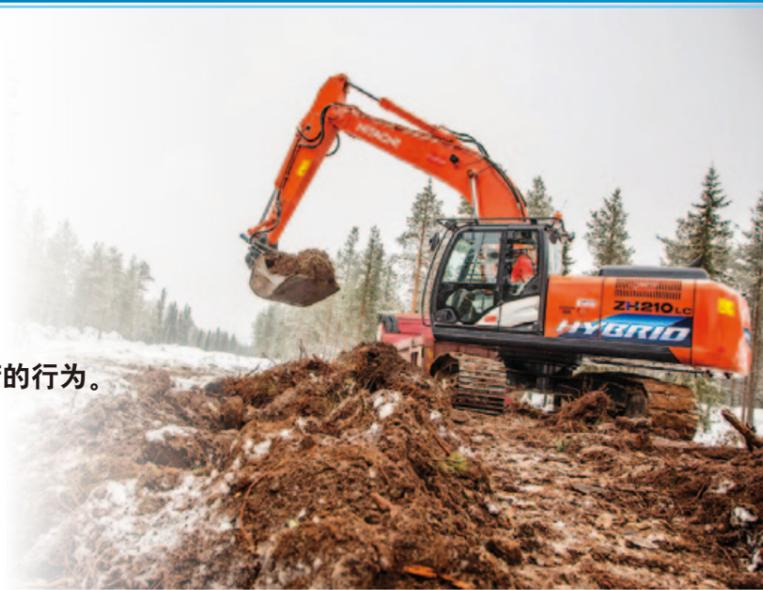
安装了低燃耗混合动力系统的“ZH210LC-5”
