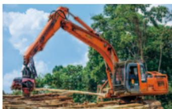
安装有处理装置的林业挖掘机
