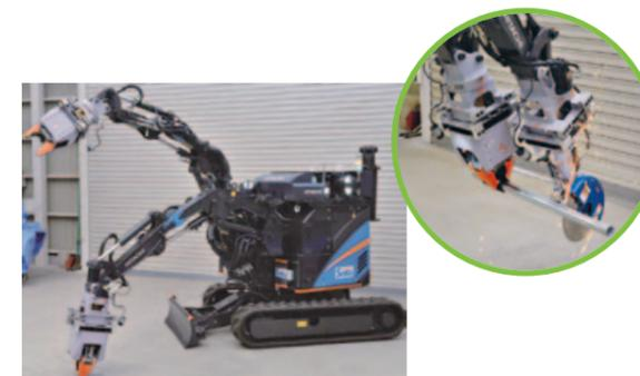
“ASTACO-SoRa”通过更换臂前端的工具，可应对大范围的作业。配备了支援操作人员的功能，在远程操作中，实现了极高的操作性能。
