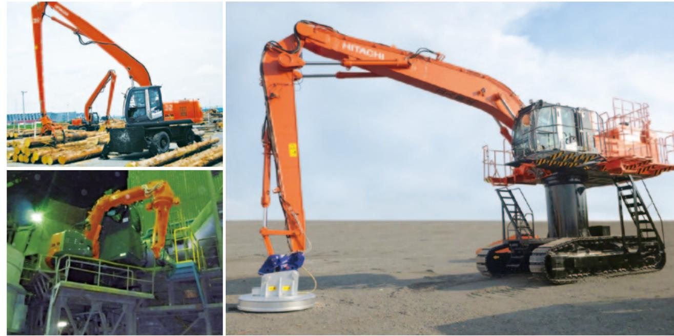
可应对顾客的个别需求的“应用开发产品”。安装了能够轻松抓取1根木材的专用抓斗的“ZX170WM-3木材抓斗型挖掘机”(左上)。以旋转臂能够清除钢包内各个角落的炉渣的“ZX75US-3电动式钢包解体挖掘机”(左下)。视野良好、能够确保大的作业范围的“ZX450LC-3高位式物料装卸挖掘机”(右)
