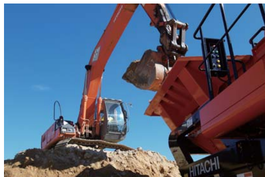
▲将原材料投入ZR950JC自走式破碎机
