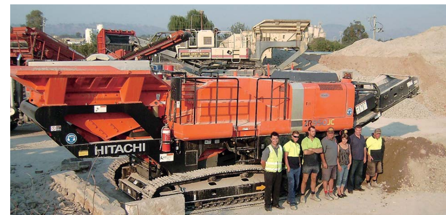
▲Jacksons Earthworks公司的ZR950JC自走式破碎机
