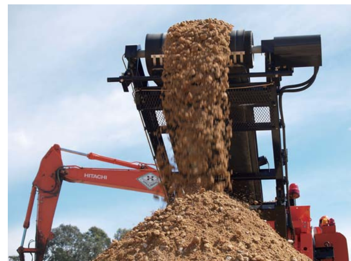
▲自走式振动筛排出的沙土
