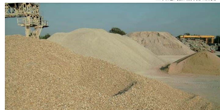
▲循环利用后的混凝土
